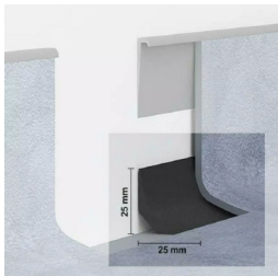
Вузол влаштування плінтуса з лінолеуму
