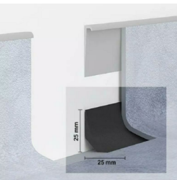
Вузол влаштування плінтуса з лінолеуму
